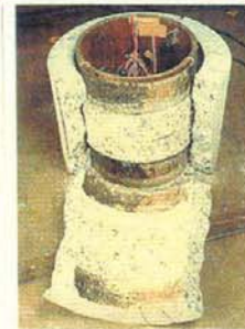
■格点部押し抜き試験
