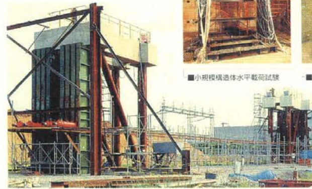
■実大規模構造体水平載荷試験
