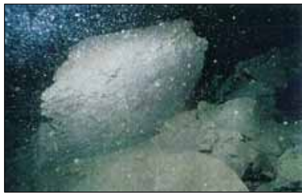
海砂利採取跡(径 50 ~ 100cm の硬い粘土塊が散在) 11)
