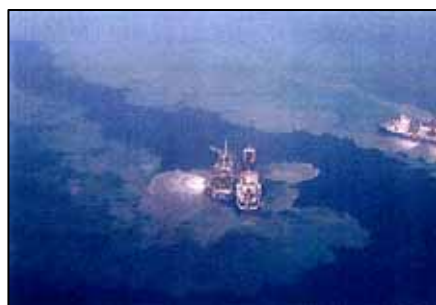
海砂利採取船から排出される濁り 11) (海砂利採取期間中、備讃瀬戸では透明度の低下がみられた)
