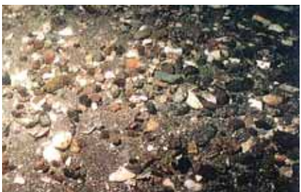
海砂利採取跡(砂分の選択的採取により礫化) 11)
