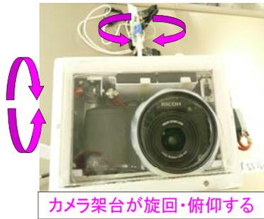
カメラ架台が旋回・俯仰する
