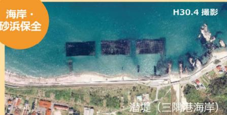
浚渫土砂を有効利用したサンドリサイクルや突堤・潜堤等の整備、予測を重視した順応的な砂浜管理等による海岸・砂浜の保全
