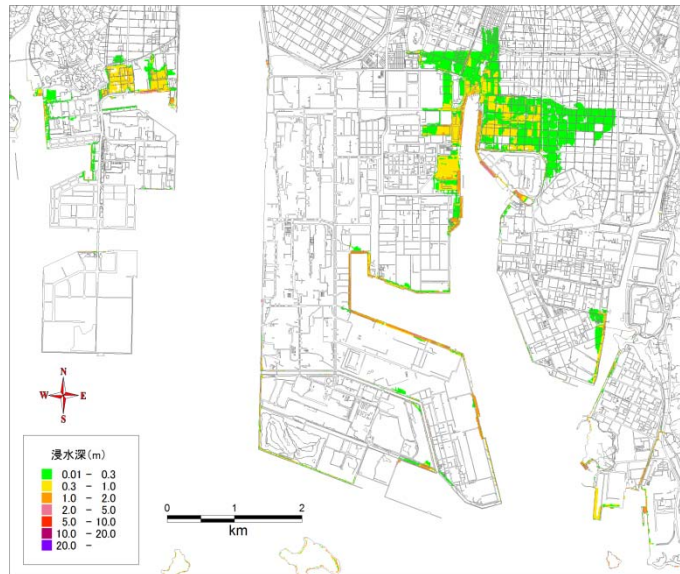
沈下条件(50%非超過)の最大浸水深分布(ケース⑥)
