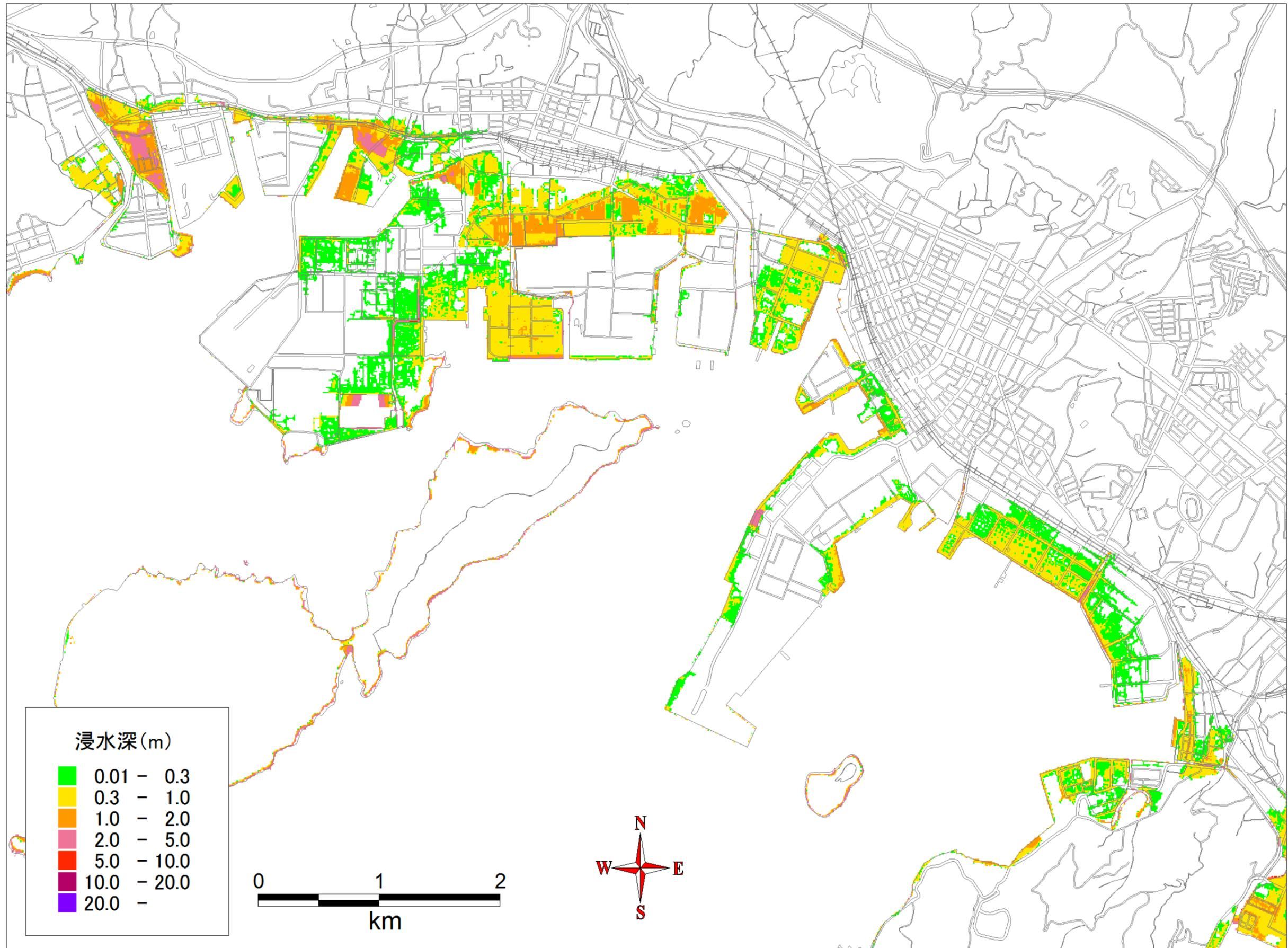
図 6 最大浸水深分布（徳山下松港・50%非超過沈下条件、津波ケース⑤）
