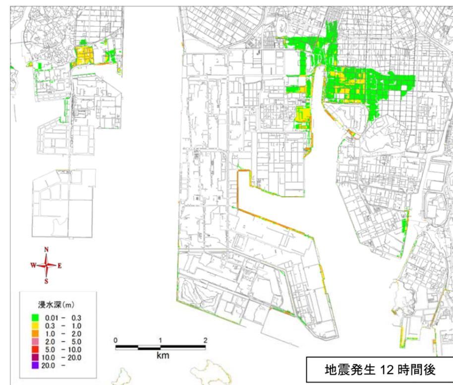
時間別の浸水深分布（地震発生 12 時間後まで） 水島港・50%非超過沈下条件 津波ケース⑥
