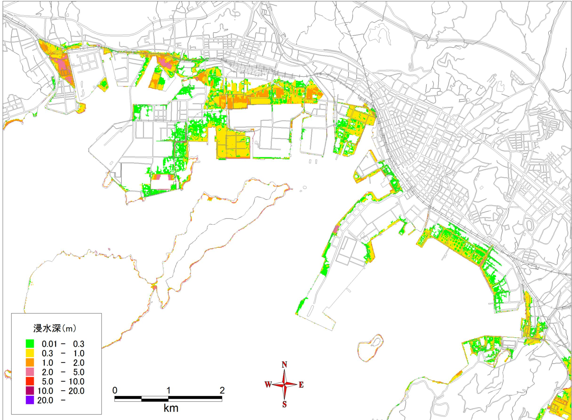
図 8 最大浸水深分布（徳山下松港・50%非超過沈下条件、津波ケース⑪）
