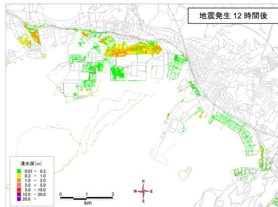
時間別の浸水深分布（地震発生 12 時間後まで） 徳山下松港・50%非超過沈下条件 津波ケース⑥
