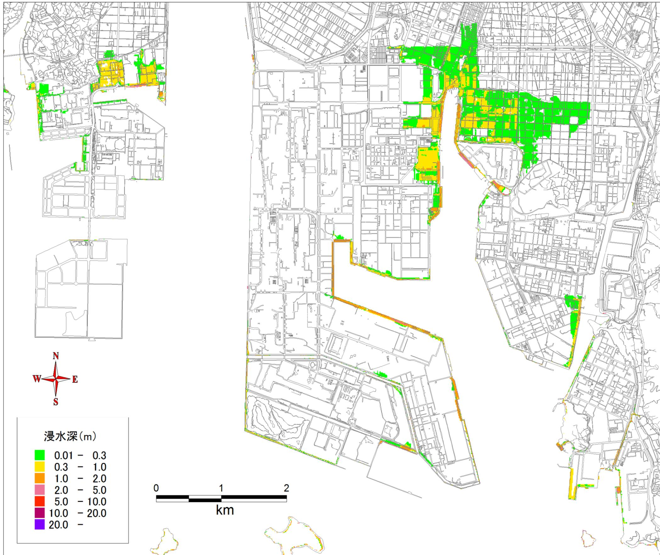
図 2 最大浸水深分布（水島港・50%非超過沈下条件、津波ケース⑥）
