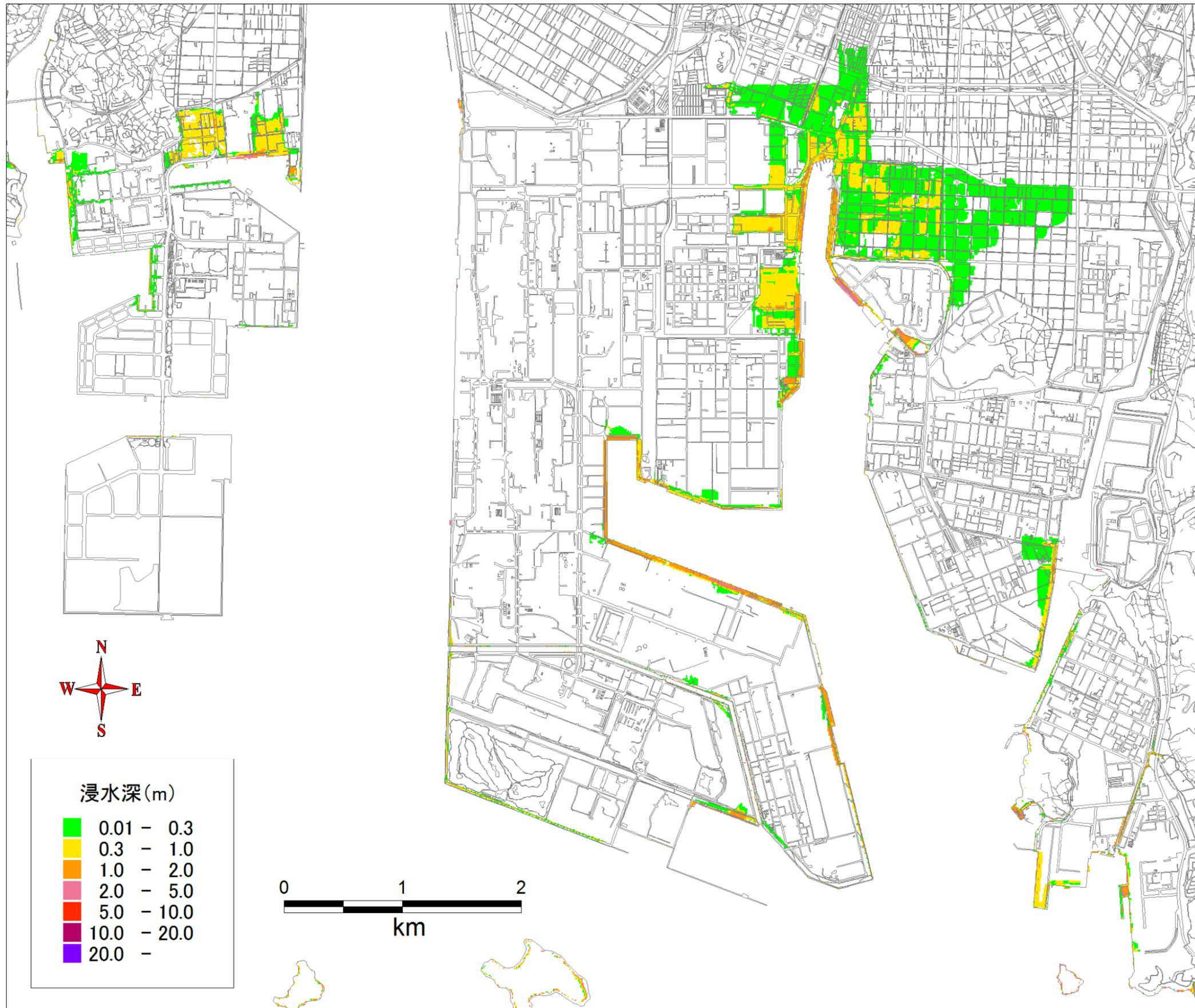
図 4 最大浸水深分布（水島港・50%非超過沈下条件、津波ケース⑧）
