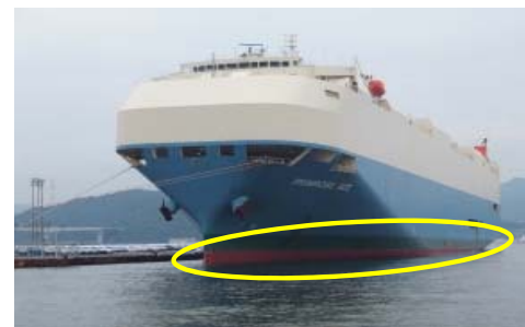
岸壁水深の不足 (喫水調整)
