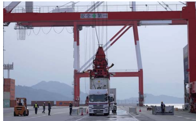
○トレーラーからコンテナを吊り上げる
