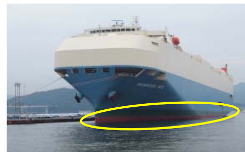
岸壁水深の不足 (喫水調整)
