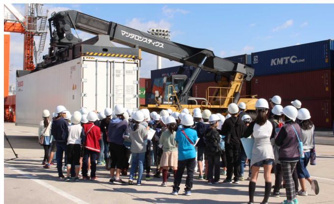
リーチスタッカーでコンテナを持ち上げる様子
